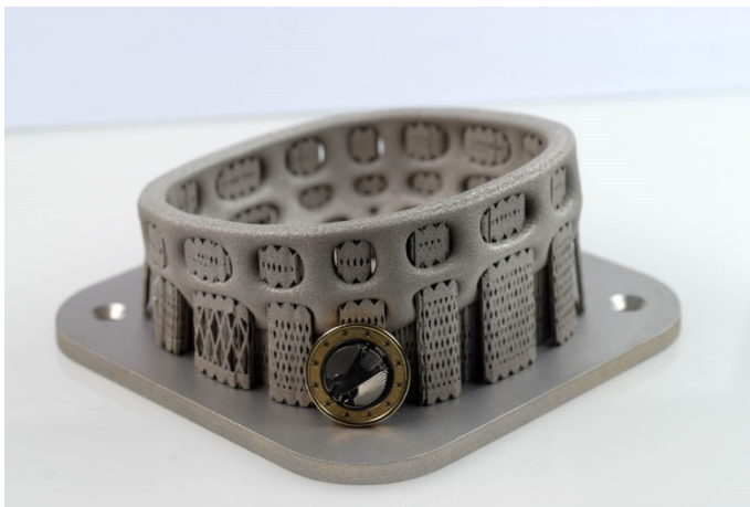
Bildunterschrift Abbildung 2: Individuelle Produkte mit komplexen Geometrien: Mit dem Selektiven Laserstrahlschmelzen (SLM) lassen sich Prototypen und Kleinserien schnell und kostengünstig fertigen – wie beispielsweise diesen Korb aus einer Magnesiumlegierung. (Foto: LZH)
